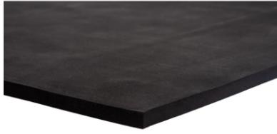
Rembourrage élastique pour sols ou murs à poser sous les tapis ou rouleaux en caoutchouc. Le revêtement à double couche ainsi obtenu gagne considérablement en élasticité et en souplesse. La matière dispose d'une structure cellulaire fermée et donc d'une capacité maximale d'absorption de l'eau de 3 %.
