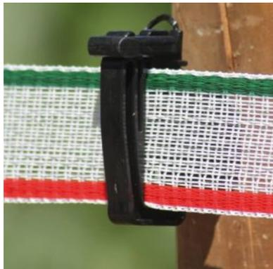
**RUBAN BLANC/VERT/ROUGE, 200 MTR 40 MM, 0,50 MM PE + 15\*0,20 INOX, RUPTURE 300 KG, RÉSISTANCE 1,52 OHM/MTR**
