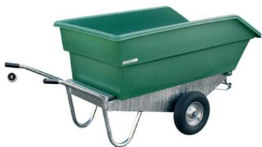
Ces brouettes sont conçues à partir d'un châssis galvanisé à basculement intégral et d'une cuve en résine de polyéthylène stabilisé aux UV et au gel. Equipées de roues de 400 x 8 - 4 plis gonflables sur roulement à rouleaux graissés avec épaulement de 80 mm, jantes métalliques (hors modèle 200 L).
