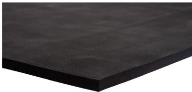
Rembourrage élastique pour sols ou murs à poser sous les tapis ou rouleaux en caoutchouc. Le revêtement à double couche ainsi obtenu gagne considérablement en élasticité et en souplesse. La matière dispose d'une structure cellulaire fermée et donc d'une capacité maximale d'absorption de l'eau de 3 %.
