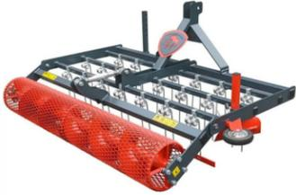
Niveleuse de piste avec rouleau de treillis. Conçue spécialement pour les surfaces de sable de quartz combinées avec des morceaux de géotextile. Finition fine de la surface supérieure sans endommager la sous-structure. Équipée de trois rangées de dents de nivellement. La fixation est équipée d'une roue de guidage de 100 mm et d'un niveleur de bord ainsi que d'un support de stationnement pour le stockage. Mécanisme de levage manuel ou hydraulique.
