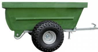
Pour traction par micro-tracteur ou quad. Cuve basculante fixée sur châssis avec 2 roues.
