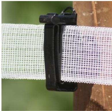
**RUBAN BLANC, 200 MTR 40 MM, 0,28 MM PE + 8\*0,16 INOX, RUPTURE 90 KG, RÉSISTANCE 5,10 OHM/MTR**
