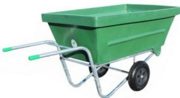
Système de basculement (breveté) permettant de vider très facilement la brouette, l'inclinaison à 165° la vide entièrement en un seul geste et la cuve revient dans sa position initiale. Cuve grande capacité, fixée sur un châssis avec 2 roues (chambres à air) de 400 X 80 montées sur roulement à rouleaux.
